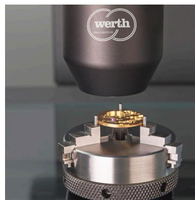
Messung einer Uhrenplatine mit dem Chromatic Focus Line CFL
