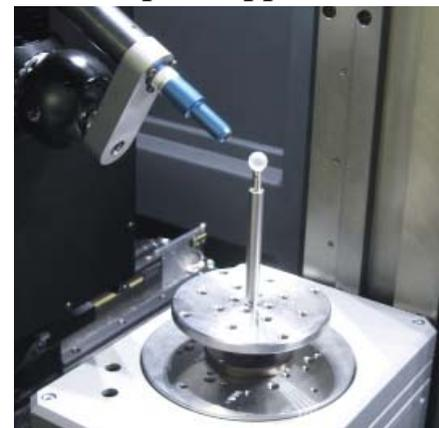
Messung einer Glaskugel mit dem Chromatic Focus Probe am Dreh-/Schwenkgelenk.
