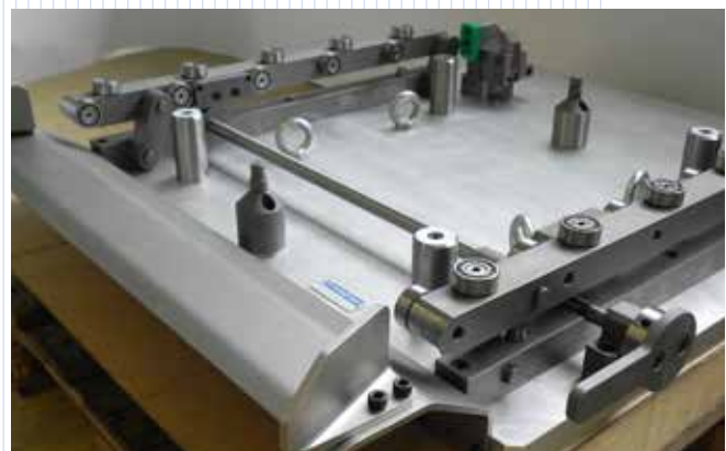
Spannstation für Koordinatenmessmaschine Clamping station for CMM
