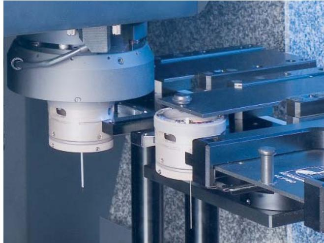
Der Werth Interferometer Probe WIP in der Tasterwechselstation
