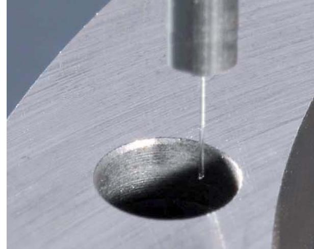
Bohrungsmessung mit dem Werth Interferometer Probe WIP
