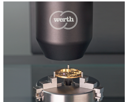
Messung einer Uhrenplatte mit dem Chromatic Focus Line CFL
