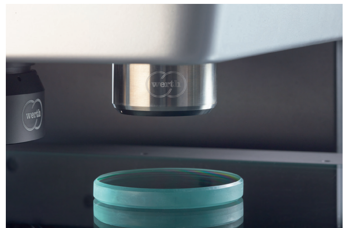
Messung einer Linse mit dem Chromatic Focus Point Sensor CFP
